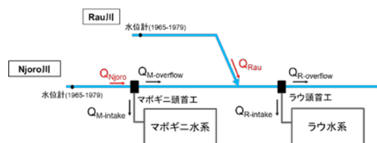
図1 ローアモシかんがい地区の用水系統 (左:マボギニ地区, 右:ラウ地区)
